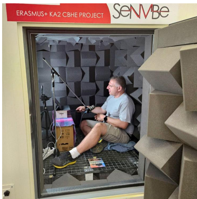
Slika 2. Postavka opreme tokom snimanja u anehogenoj komori.
