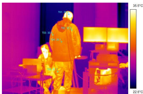
Slika 5. Dat je prikaz ispitanika sa opremom kada je brzina trake 6 km/h, sa nagibom od 7% i vremenom trajanja nakon tri minuta
