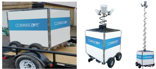
Slika 4. CoW koja se vuče ili transportuje na prikolici [16]
