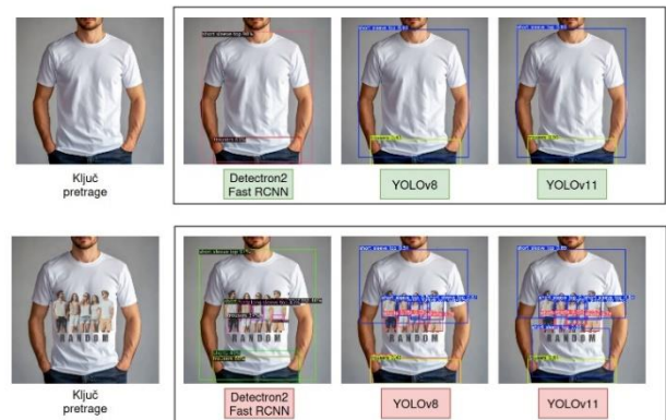
Slika 1. Primjer detekcije lažno pozitivnih uzoraka, kada je na majici prikazan neki broj ljudi
