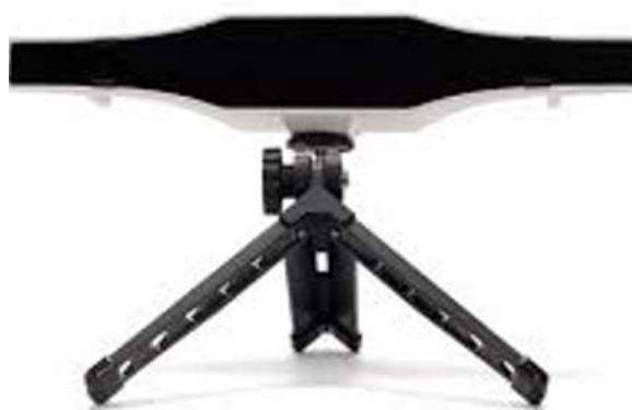
Slika 3. Uređaj za praćenje pokreta očiju Gazepoint G3
