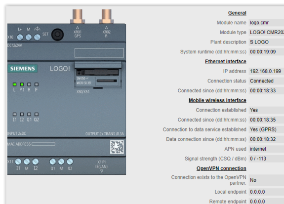
Slika 3. GSM/GPRS modul Siemens LOGO!CMR200
