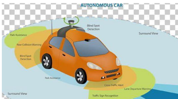
Slika 5 Kamere i senzori samovozećeg automobila
