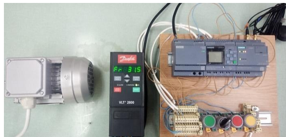
Slika 2. Sistem za daljinski nadzor i upravljanje asihronim motorom
