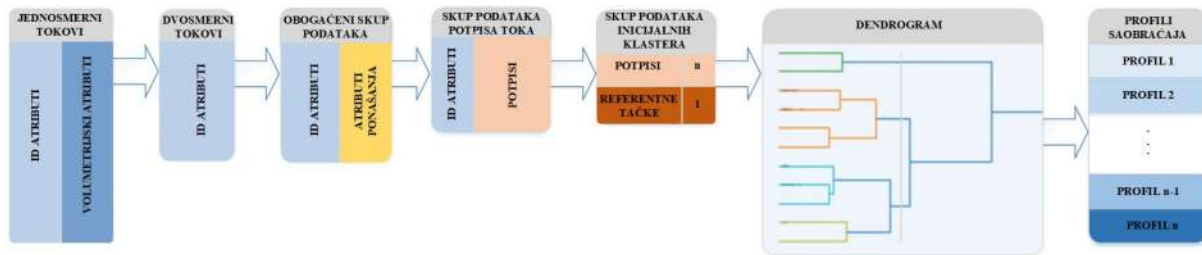
Slika 1. Proces detekcije anomalija i napada primenom modifikovanog HAC algoritma
